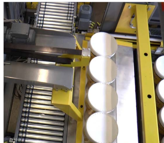
Palletering af spande
